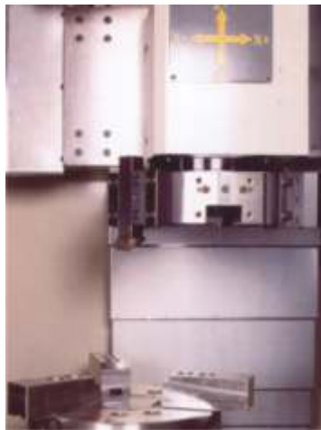
E – с горизонтальной револьверной головкой
