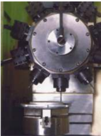
C – с вертикальной револьверной головкой с приводом вращающегося инструмента и позиционированием шпинделя с дискретностью 5°
