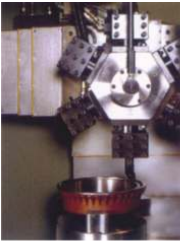
A – с вертикальной 6-ти позиционной револьверной головкой
