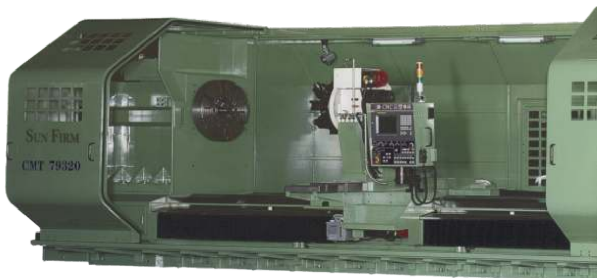
СМТ-79320 с осью "С", приводом вращающегося инструмента и восьмипозиционной головкой. Расстояние между центрами 320" (8000мм). Диаметр над станиной 79" (1975мм).
