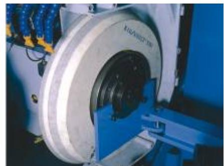
**Шпиндельная внутришлифовальная головка (опция для GU - серии)** - устанавливается на шлифовальной бабке на шарнире и, в случае необходимости, может быть быстро переведена в рабочее положение.
