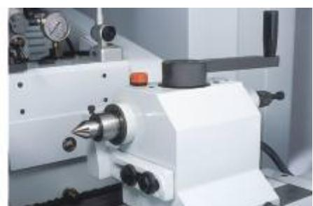
Держатель правильного инструмента для шлифовального круга, устанавливаемый на передней бабке (для GA-серии)
