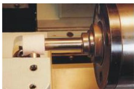
Держатель правильного инструмента для шпиндельной внутришлифовальной головки
