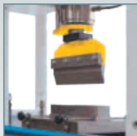
Инструмент для гибки длиной 415 мм.
