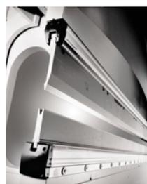
▶ Система крепления инструмента типа WILA
