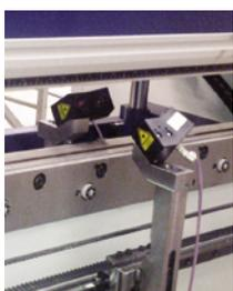
▶ Лазерная система измерения угла
