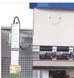
▶ Лазерный барьер безопасности AKAS с моторизованной регулировкой
