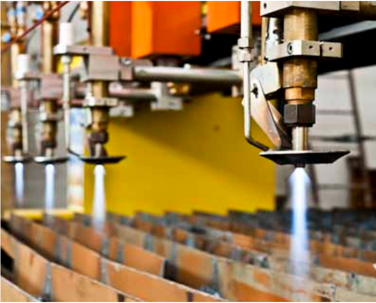
определение высоты горелки в процессе резки, автоподжиг Capacitive height control, electric ignition
